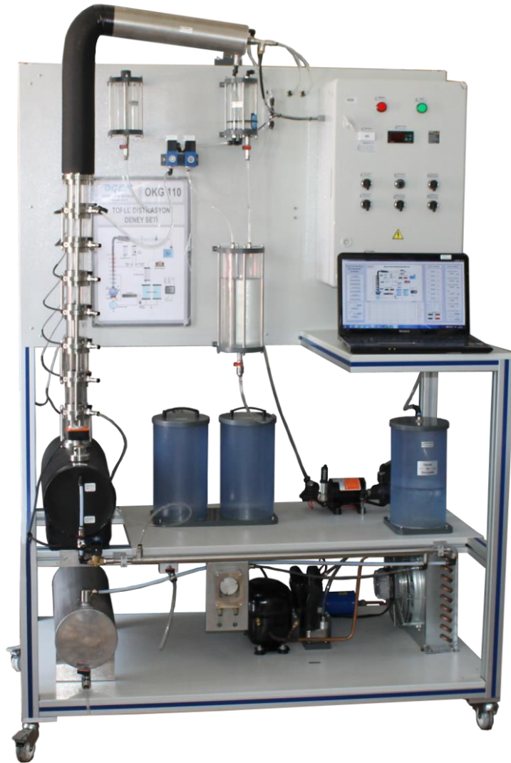
Şekil 4.5.9. Destilasyon deney sistemi
