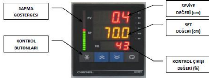
Şekil 4.9.3 Proses kontrol cihazı
