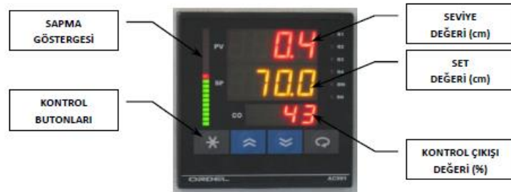
Şekil 4.7.2 Proses kontrol cihazı
